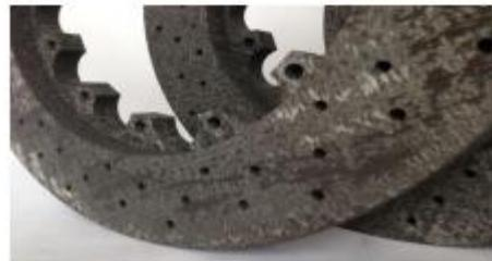
中国在全球第一个完成了碳陶刹车盘，并且已经应用于军用飞机的7个机型上，这项技术是源自2004年的国家科技发明一等奖的陶瓷基复合材料制备技术。
