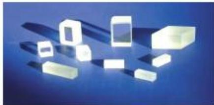
非线性光学晶体是对于激光强电场显示二次以上非线性光学效应的晶体。非线性光学晶体，是高新技术和军事技术不可或缺的关键材料之一，直接影响激光技术的发展进程。1990年，中国材料界的泰斗陈创天院士研究组研发出全球第一块KBBF晶体，KBBF成为控制激光武器的“命门”。
