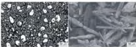
图4 高铬铸铁的典型显微组织
